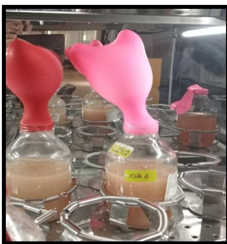
Figure IV.2 : Photo de gonflement des ballons qui dû à la libération de CO 2 .
