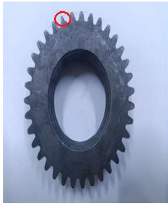
b) engrenage défectueux
