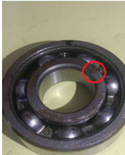
Figure VI.5: Le roulement défectueux
