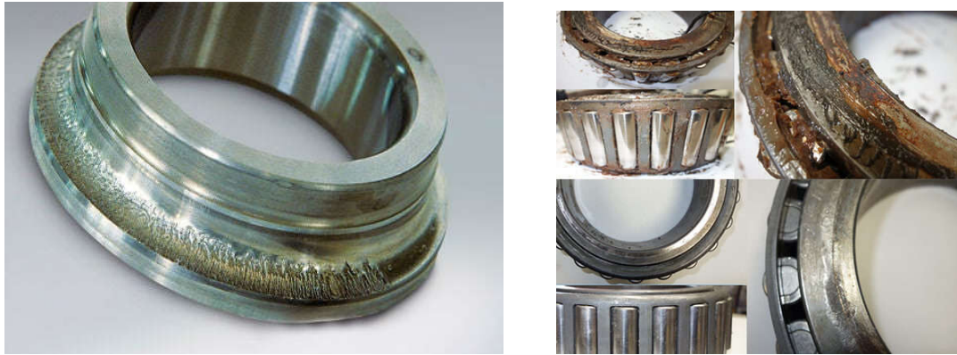
Figure I.12 : Exemple de dégradation par écaillage sur des bagues de roulement [12]
