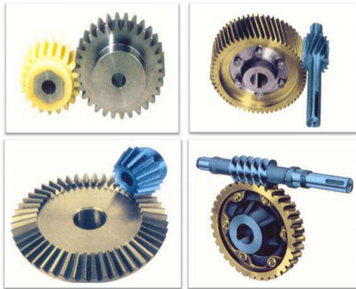
Figure I.2: Les Types d'engrenages utilisés dans l'industrie : (a) Engrenage parallèle, (b) Engrenage hélicoïdal, (c) Engrenage conique et (d) Roue et vis sans fin [61].
