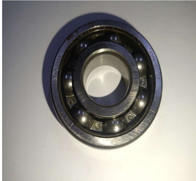
Figure VI.4: Roulement utilisé pour les essais de type SKF explorer 6305/2z/c3
