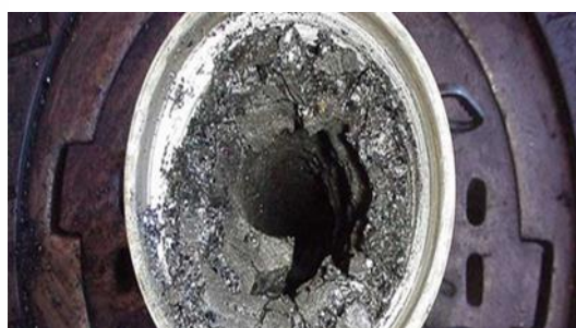
Figure II. 2 : Exemple d'une canalisation bouchée partiellement par un dépôt d'asphaltènes. [32]
