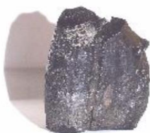
Figure II. 2 : Exemple d'une canalisation bouchée partiellement par un dépôt d'asphaltènes. [32]
