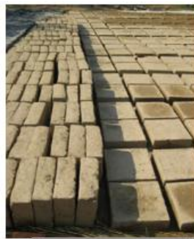
Figure I.9: Séchage de brique en adobe
