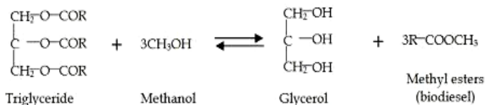
Figure I.2. Schéma de la production du biodiesel à partir d'oléagineux [1].
