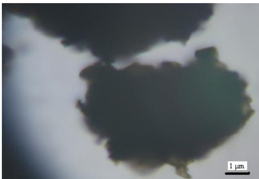
Figure III.3. Forme et taille des particules du catalyseur à 20% V_2O_5 +15% MoO_3/\gamma Al_2O_3
