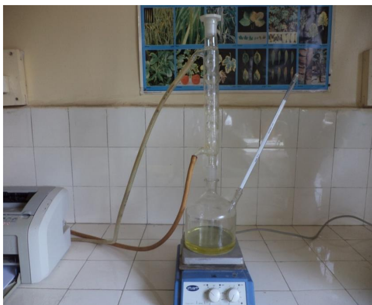
Figure II.3. Le dispositif utilisé lors de la réaction d'oxydation du glycérol en phase liquide.
