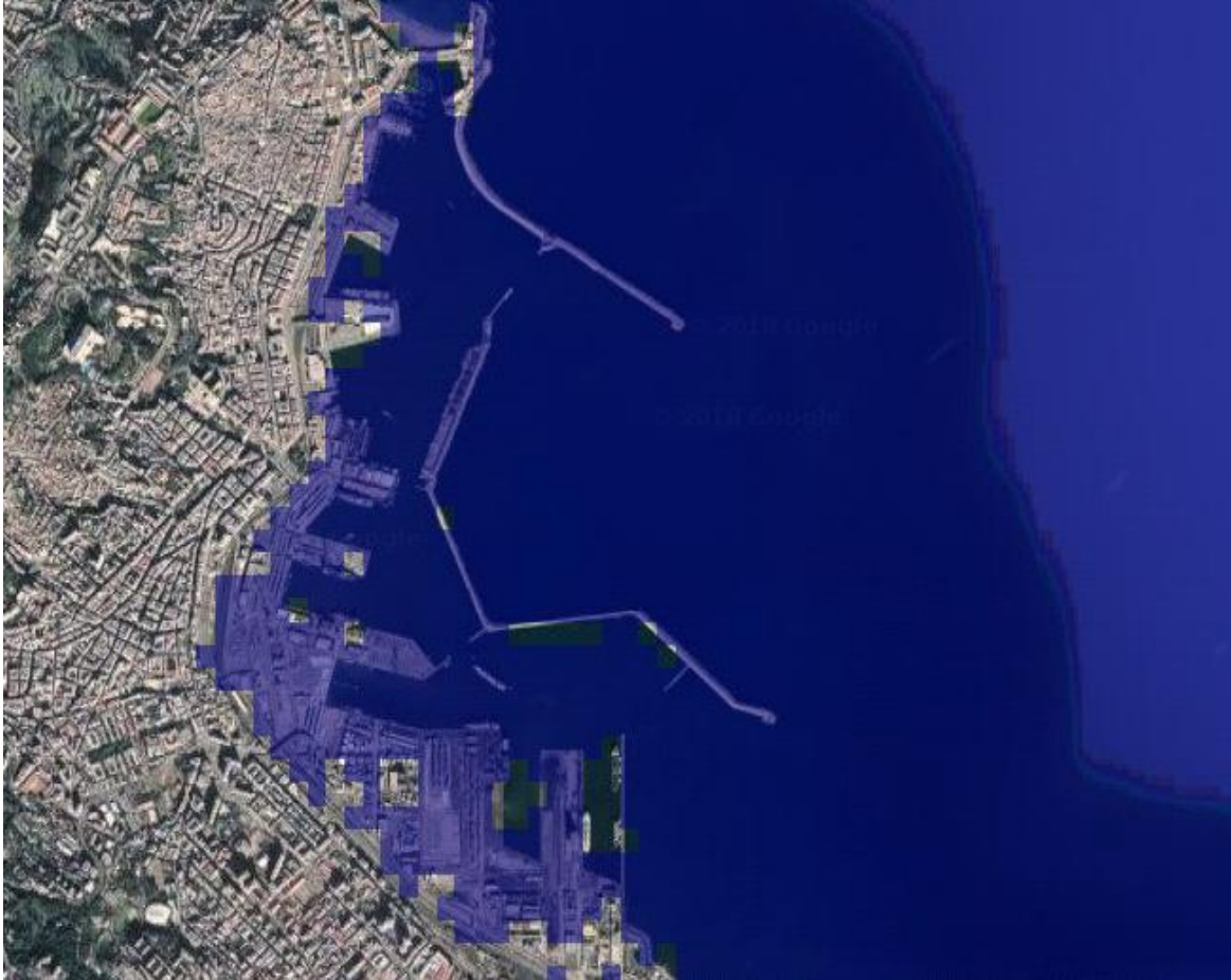
Figure 32 simulation de la remontée des eaux d'ici 2100 d'environ 2m. Source : http://sboisse.free.fr/planete/simulateur-de-montee-des-oceans.php
