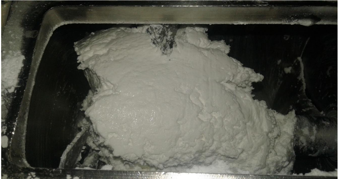
Figure 3.4 : la pate formée à partir de 481 ml d'éthanol
