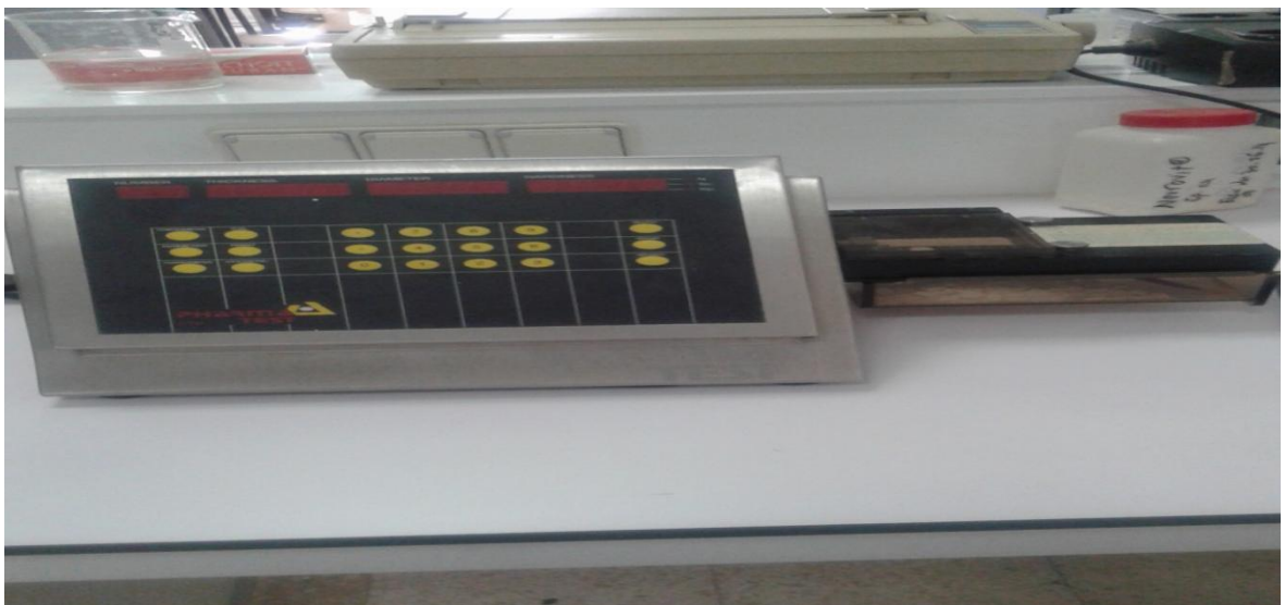
Figure 2.11 : Appareil de détermination de la dureté des comprimés.
