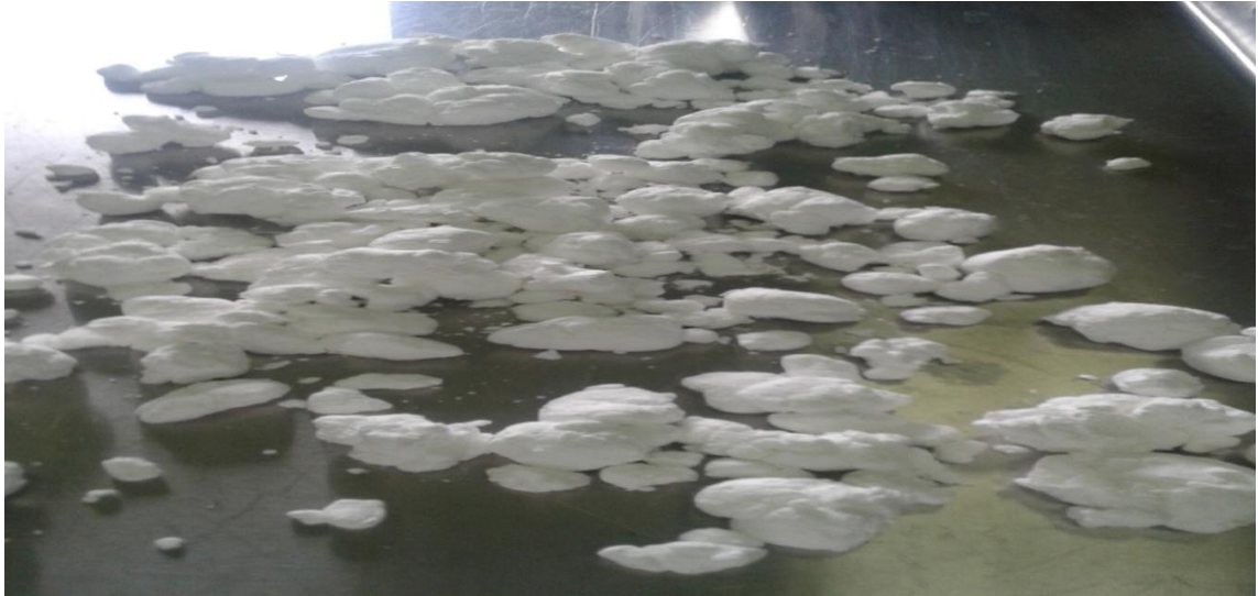
Figure 3.1: la pate formée à partir de 388,5 ml d'éthanol
