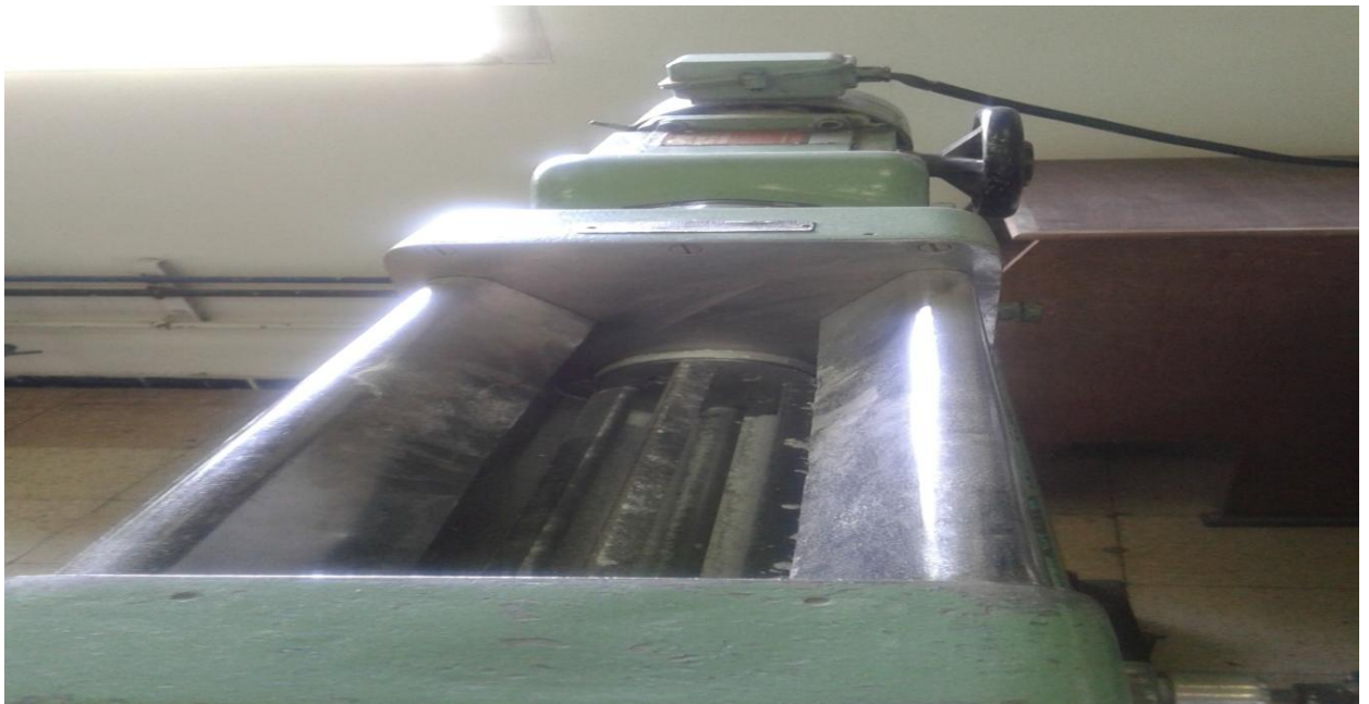
Figure 2.4 : Photo d'un granulateur oscillant
