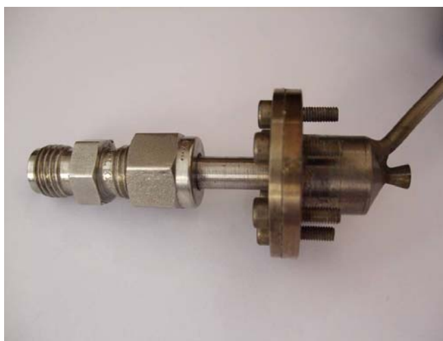
Figure 5.15 : Modèle d'engineering du propulseur monoergol
