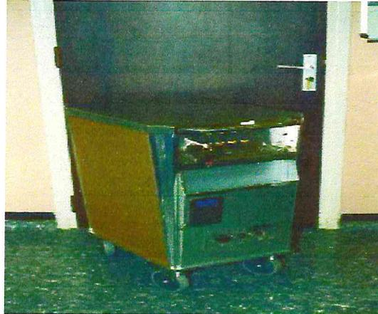
*Figure 3 : Projecteur de sources de Césium-137 (type Curietron) [16].*
