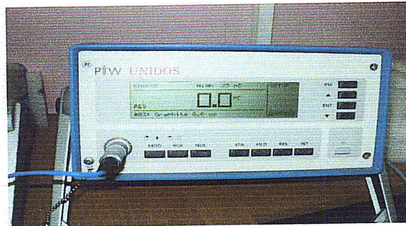
Figure III.8 : Electromètre Unidos type T10002-20714.
