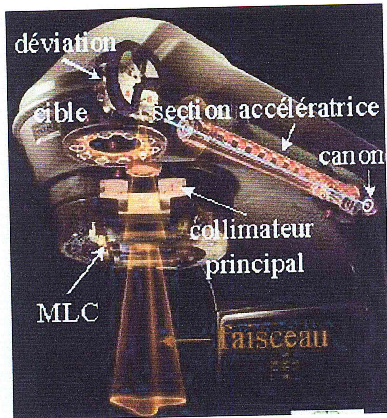
Figure II.7 : Schéma d'un accélérateur linéaire électrons-photons (Varian 2100C)
