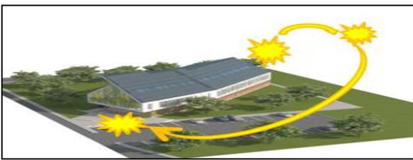
Orientation du bâtiment et positionnement de la fenestration [50,7 % au sud, 19,5 % à l'ouest] optimisant l'apport énergétique passif
