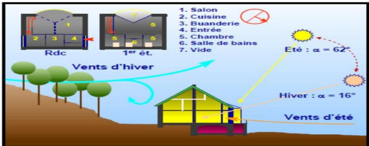
Figure 17 : L'implantation tient compte du relief, des vents locaux, de l'ensoleillement. Source Traité d'architecture et d'urbanisme bioclimatique, 2005
