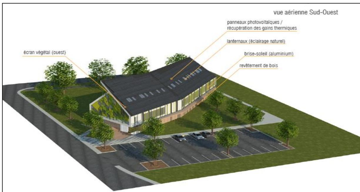
Figure 38 schéma de synthèse des installations actives et passives dans la bibliothèque net-zéro de Varennes (source : Martin Damphousse, 2014).
