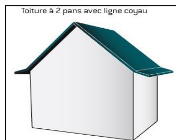
Figure 6:toit à 2 pans avec ligne coyau.
