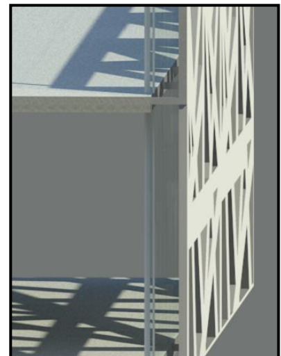
Figure 74: détail de façade double peau. Source : auteur.
