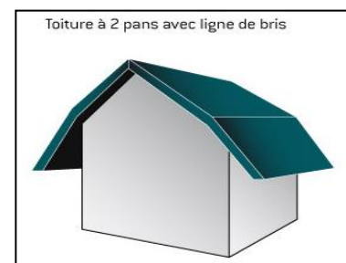
Figure 5: toit à 2 pans avec ligne bris.
