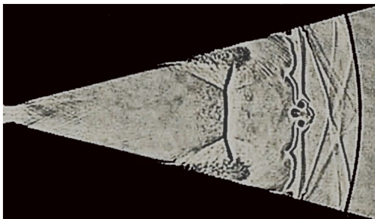
Figure 1.16: Décollement effectif lors d'un amorçage rapide, [52].
