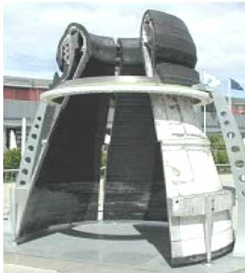
Figure 2.12 : Tuyère de propergols solides [3].
