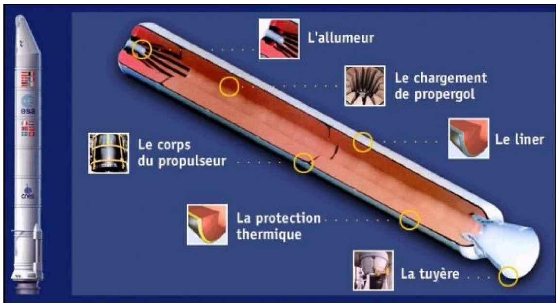
Figure 2.11 : Eclaté d'un EAP (CNES) [3].
