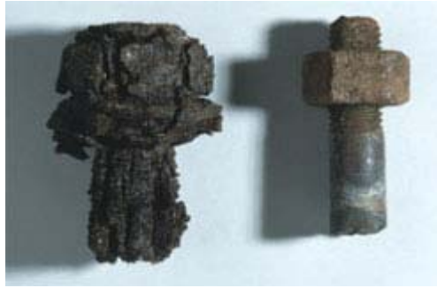
Figure 4.1 : Ecrous : celui de gauche est très corrodé.
