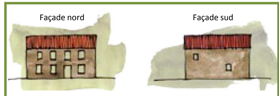
Fig.20 Ouvertures maximum au nord pour favoriser les vents froids du nord et ouvertures réduites au sud pour se protéger de l'ensoleillement en été.
