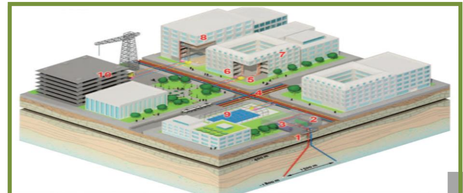
Fig.18 Centrale géothermique d'un réseau de chaleur
