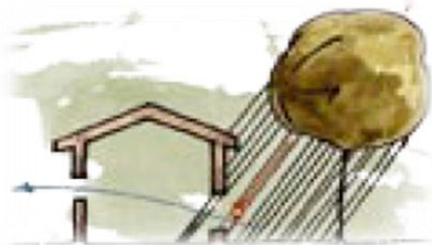
Fig.21 Protection du soleil en été par la végétation ouverture au nord pour favoriser la ventilation
