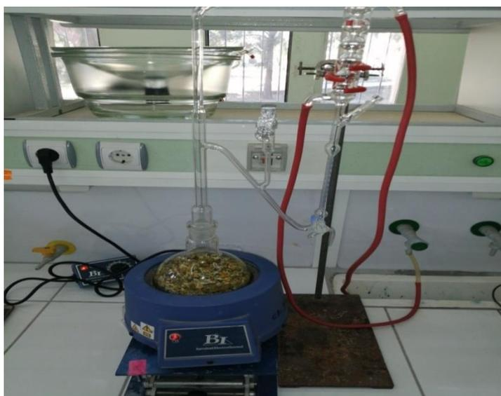
**Figure II.3 :** Montage d'hydrodistillation
