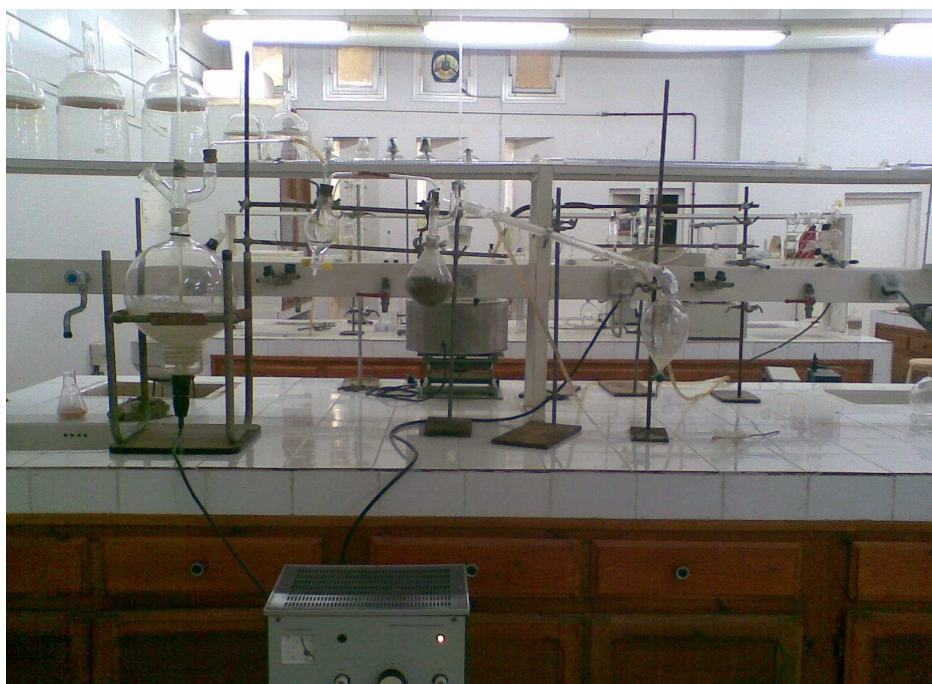
Fig.3.1 Dispositif d'extraction des huiles essentielles par entraînement à la vapeur d'eau
