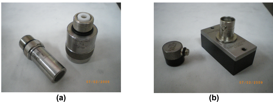
Figure 4.9: Transducteurs utilisés : (a) transducteurs à immersion (b) transducteurs par contact.
