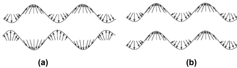
Figure 3-3. Modes de Lamb symétrique (a) et antisymétrique (b) matériau homogène isotrope [61].
