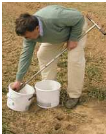
Figure 4.12 : prélèvement d'échantillon de sol à l'aide d'une tarière (Personnelle, 2010).
