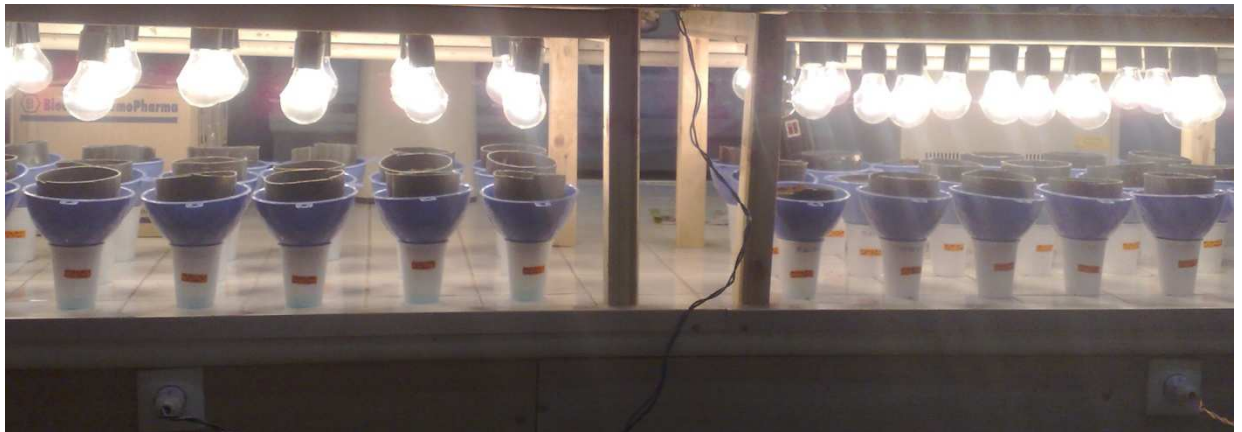
Figure 4.13 : Batterie de dispositif de Berlese r alis e au laboratoire pour l'extraction de la p dofaune (Personnelle, 2010).
