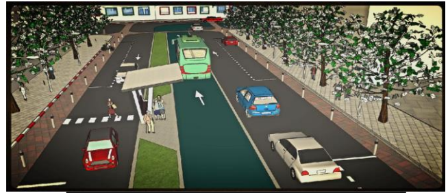
Figure 3.31 voie de bus en site propre
