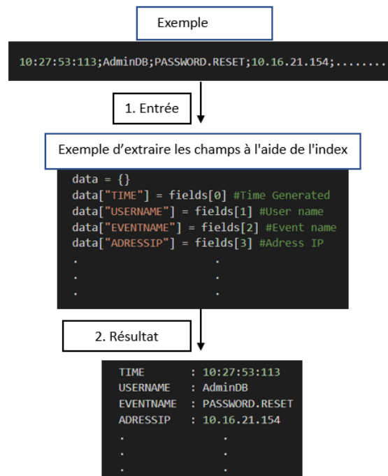
Figure 2.10: Exemple de Parsing d'un log.
