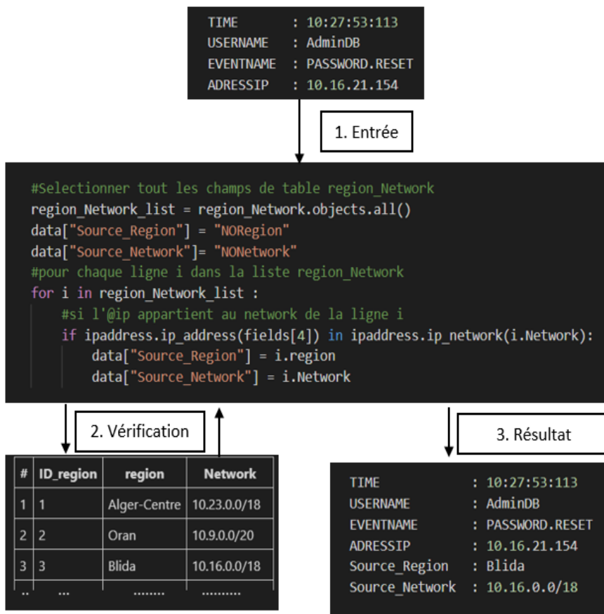
Figure 2.11: Exemple-1- d'enrichissement d'un log.
