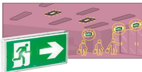
Fig. Eclairage d'évacuation , permet l'évacuation du public en assurant l'éclairage des cheminements, des sorties, des obstacles, des changements de direction et des indications de balisage ; ( https://info-elec-cpa.pagesperso-orange.fr/eclairage_secu.html )
