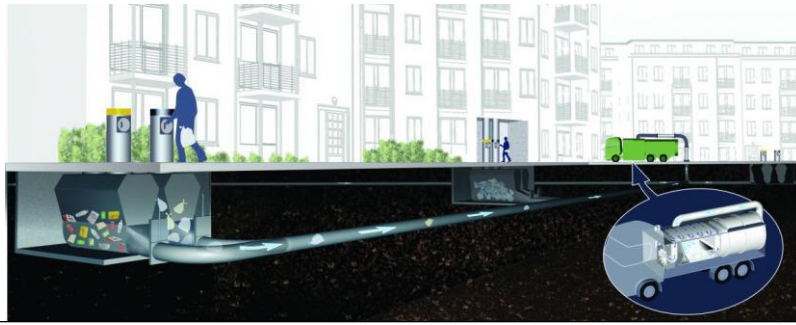
Figure 98.III. Schéma d'un système pneumatique ; ( https://www.construction21.org/france/articles/fr/tendance-green-city-solutions-awards-la-gestion-pneumatique-des-dechets.html )
