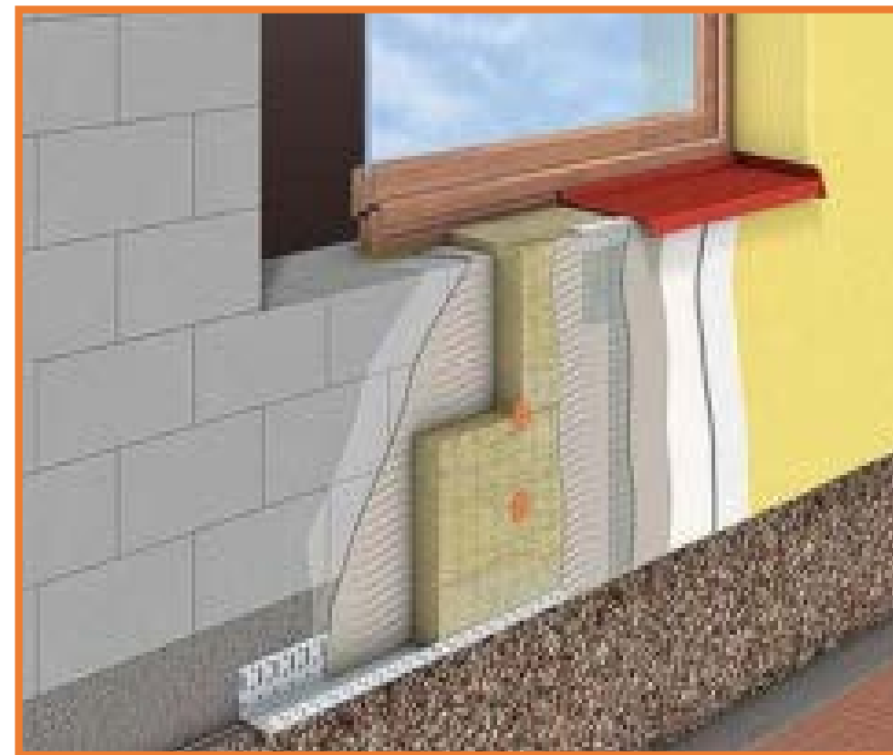
Figure : Isolation des murs par l'extérieure.
