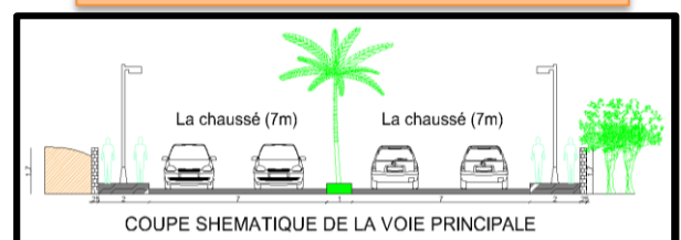
Figure 69: coupe sur la route nationale 11 Source : prise par l'auteur 2019
