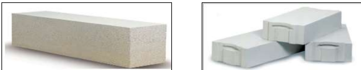
Fig.04.5.: béton cellulaire. Source : gramme.be]
