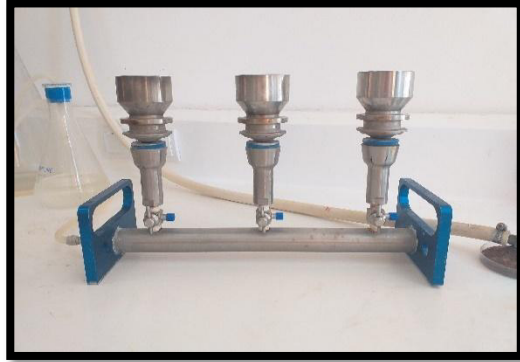
Rampe de filtration
