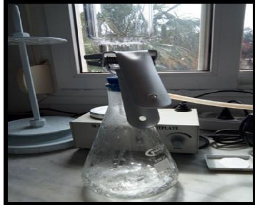
Rampe de filtration
