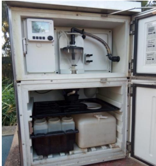
Figure 09 : Préleveur automatique de la STEP
