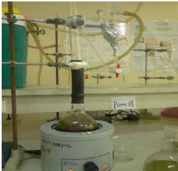
Figure 6 : Procédé d'extraction des huiles essentielles par Hydrodistillation
