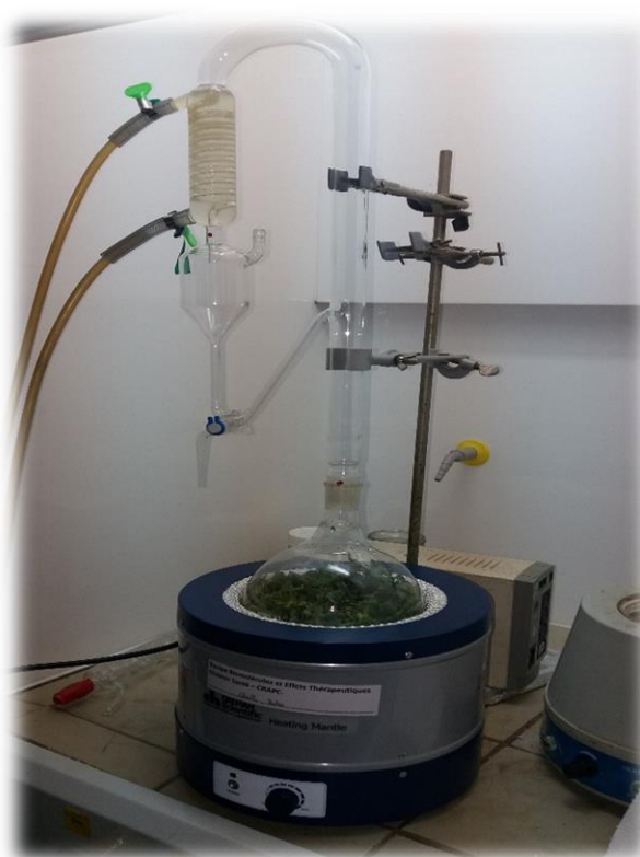
Figure 13 : Extraction des huiles essentielles d' O.floribundum par Hydrodistillation (en utilisant un Clevenger)
