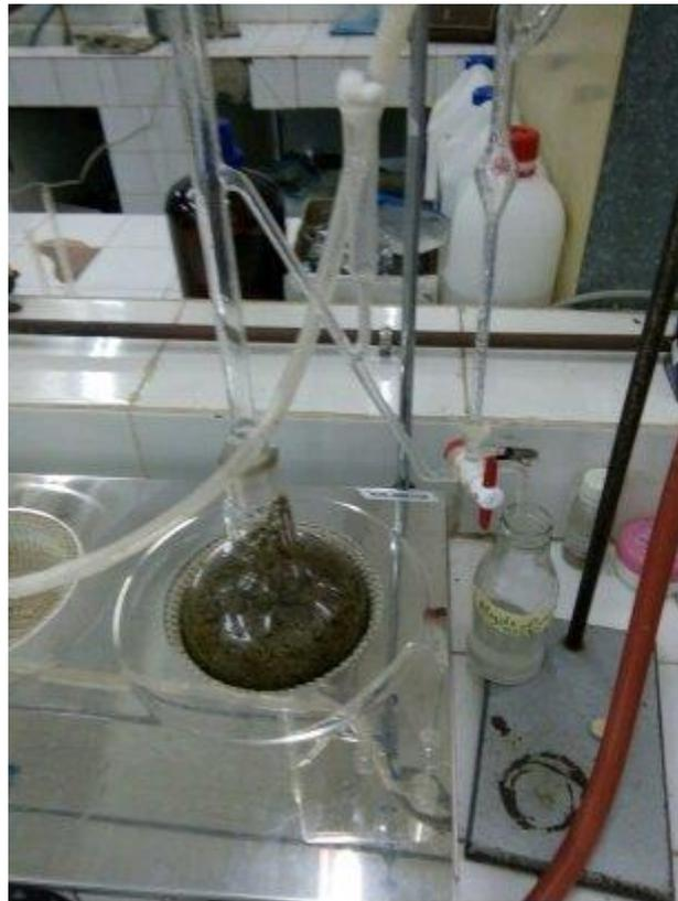
**Figure 11 : Extraction des huiles essentielles par hydrodistillation (original 2018)**
