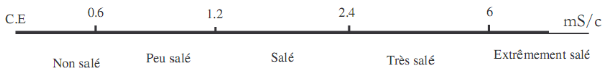
Figure 5 : échelle de salure en fonction de la conductivité de l'extrait aqueux au 1/5 relation de Richards in Aubert (1978) in Aboura (2006).
