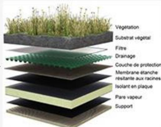
FIGURE : LES COUCHES DE TOIT VÉGÉTALISÉ
