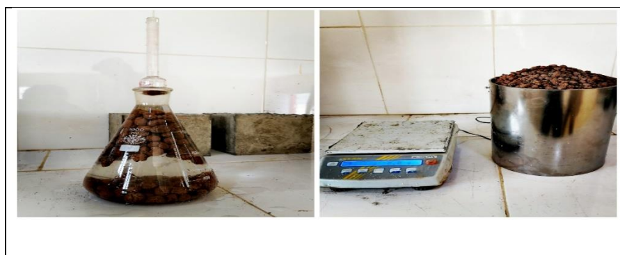
Figure 2.8 : Détermination de la masse volumique réelle et apparente des GL à l'aide d'un pycnomètre et récipient.
