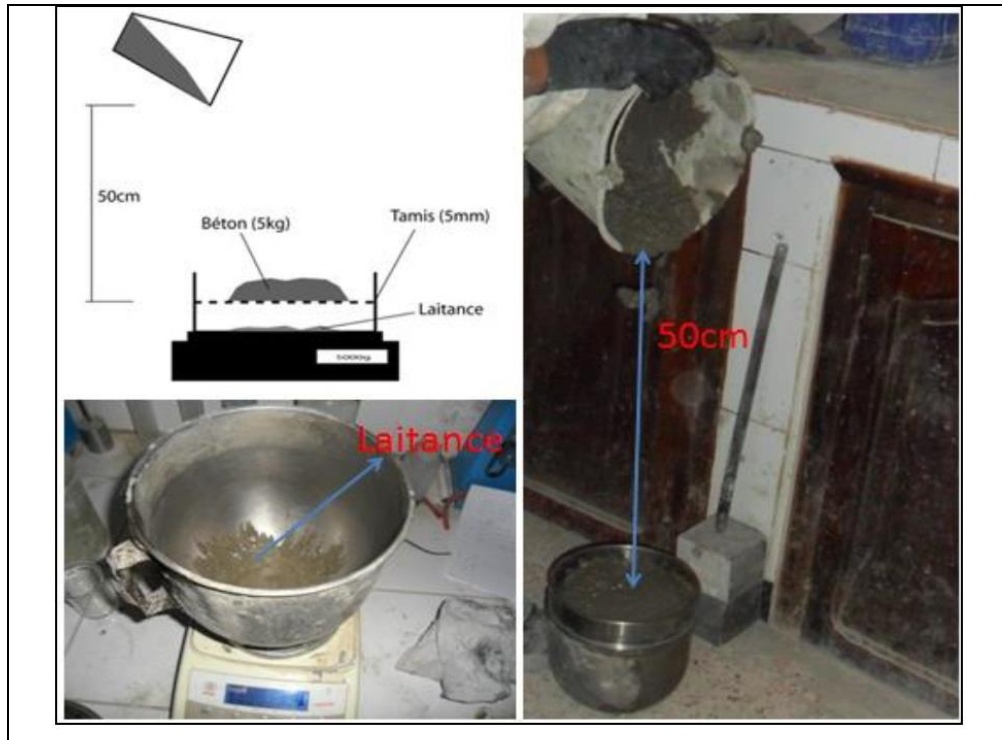
Figure 2.17 : Essai de stabilité au tamis.
