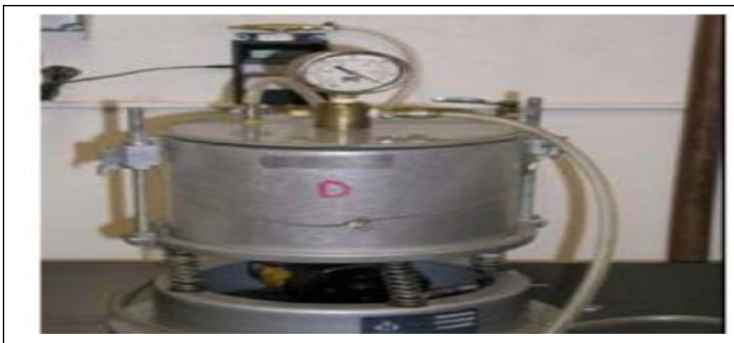
Figure 1.18 : Appareillage de mesure de l'absorption d'eau sous vide (Mills-Beale et al. 2009) [32].
