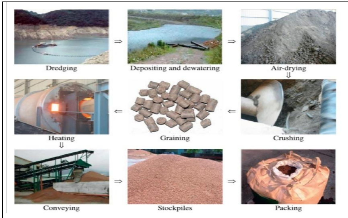
Figure 1.15 : Processus de fabrication de granulat léger à partir de boue issue de réservoir de décantation [19].
