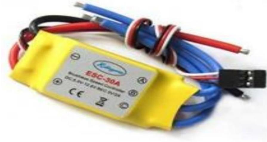
Figure(III. 7)Le contrôleur de vitesse L'ESC 30A
