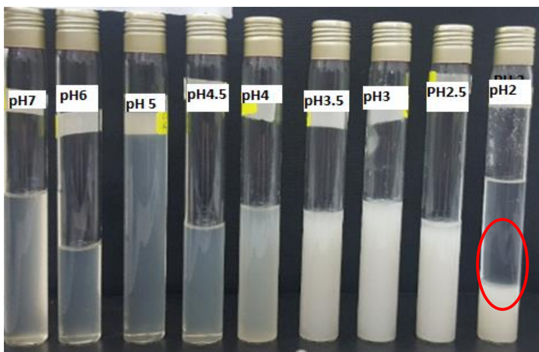
Figure V.41: Observation visuelle des essais au ratio Pr : Ps Gélatine/ Alginate de sodium 1/1 à différents pH
