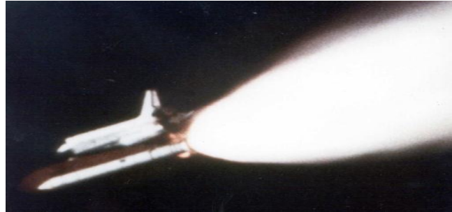
(b) Éclatement des jets des boosters de la Navette Spatiale à haute altitude. Figure 3.6 : Topologie de l'écoulement en Régime de sous-détente.
