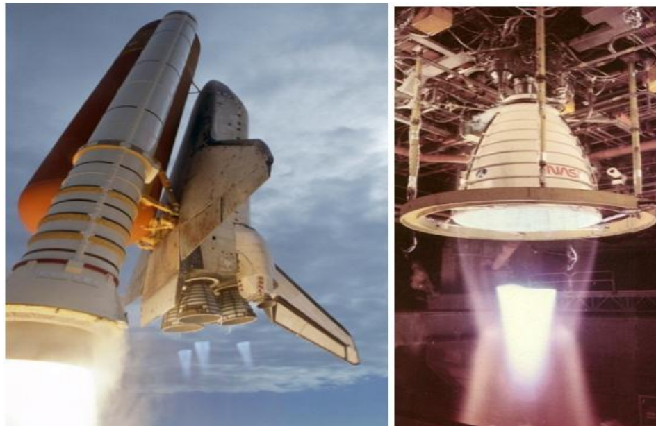
(b) Tuyère en sur-détente avec décollement naissant (Shock diamonds in Shuttle's main engine nozzles during STS-120 launch (NASA), and during tests)
