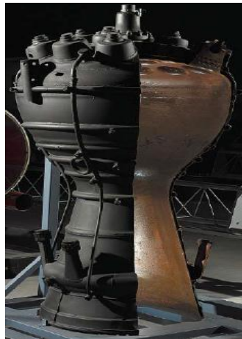
Figure 1.5 : Tuyère conique de la fusée V-2.
