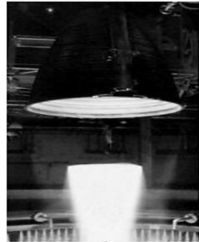
Figure 3.20 : Réflexion de Mach moteur Vulcain au banc d'essai [135].
