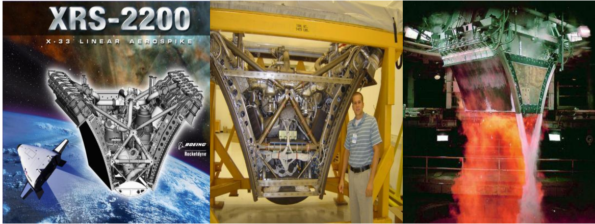
Figure 1.31 : Tuyère plane à corps central tronqué (Linear Aerospike Nozzle).
