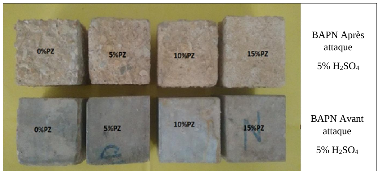
Figure 6.13: Examen visuel du BAPN avant et après attaque à 5% H_2SO_4 .
