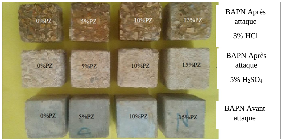
Figure 6.21: Examen visuel du BAPN avant et après attaque à 3%HCl et 5%H 2 SO 4 .
