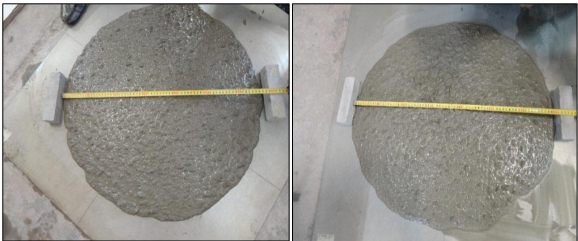
Figure 5.8 : Etalement au cône d'Abrams du BAP (50%R/50%N) (à gauche) et BAP (75%R/25%N) (à droite).
