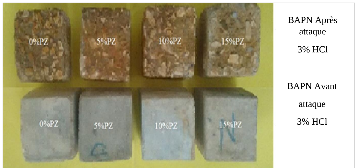
Figure 6.19: Examen visuel du BAPN avant et après attaque à 3% HCl.
