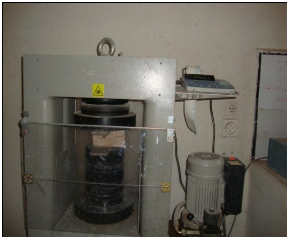
Figure 4.10 : Dispositif pour l'essai de compression.
