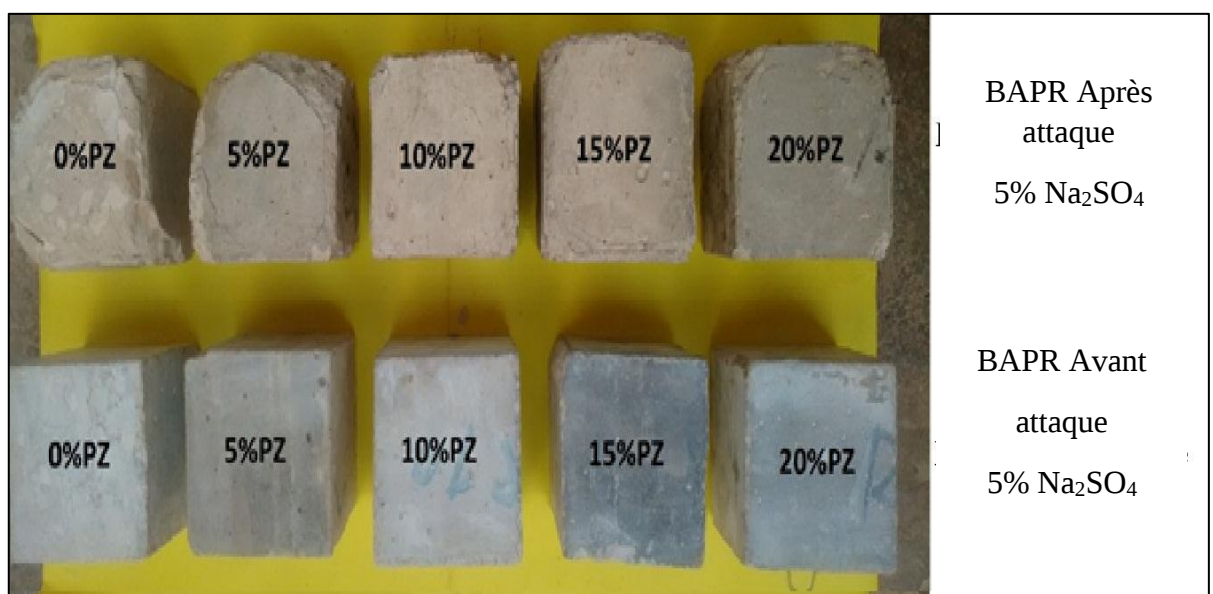
Figure 6.28: Examen visuel du BAPR avant et après attaque à 5% \text{Na}_2\text{SO}_4 .
