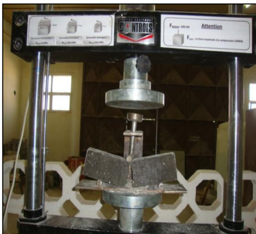
Figure 4.11 : Schéma de l'essai de traction par flexion à trois points.
