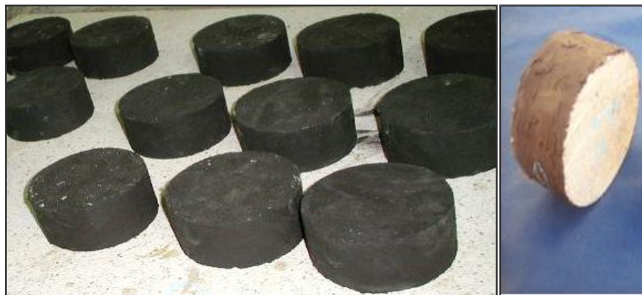
Figure 4.18 : Recouvrement des échantillons par la résine époxy.
