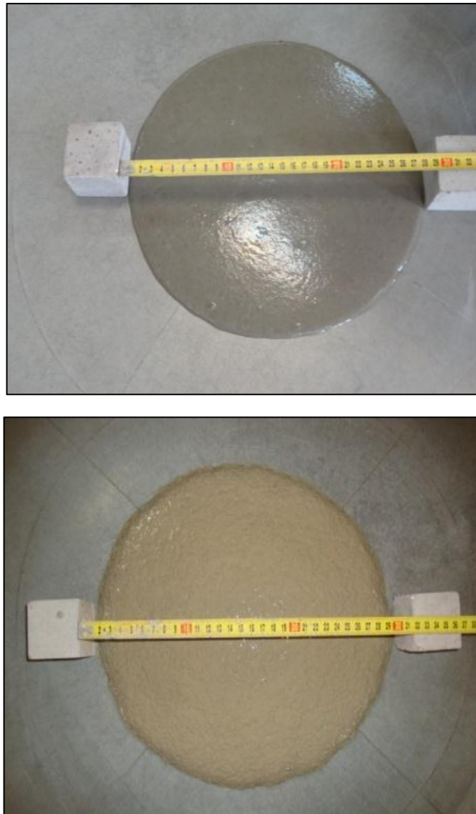
Figure 5.2 : Etalement au mini cône du mortier SN (en dessus) et mortier SR (en dessous) à un dosage de 1% de Sp.
