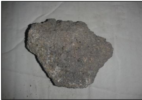
Figure 3.3 : Scories de la PN avant broyage.
