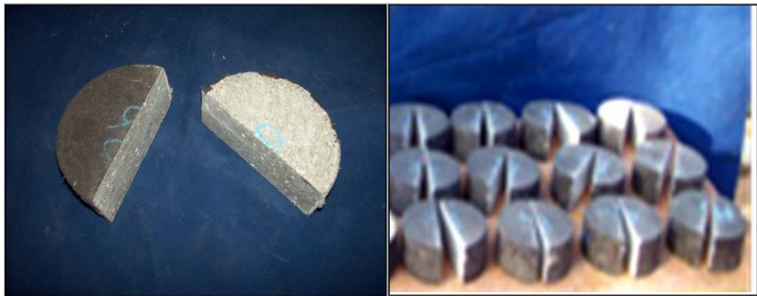
Figure 4.21 : Coupe de l'éprouvette en deux après 28,56,90 et 120 jours d'immersion totale.
