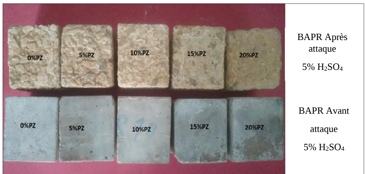
Figure 6.14: Examen visuel du BAPR avant et après attaque à 5% H_2SO_4 .
