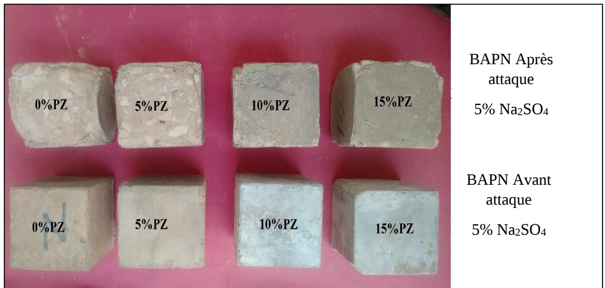
Figure 6.27: Examen visuel du BAPN avant et après attaque à 5% \text{Na}_2\text{SO}_4 .
