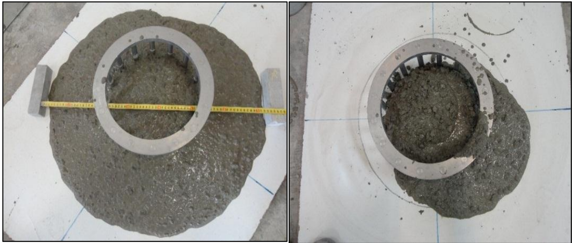
Figure 5.7 : Etalement au couronne (J-Ring test) du BAP (50%R/50%N) (à gauche) et BAP (75%R/25%N) (à droite).
