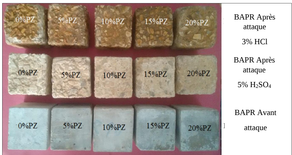
Figure 6.22: Examen visuel du BAPR avant et après attaque à 3% HCl et 5% H 2 SO 4 .
