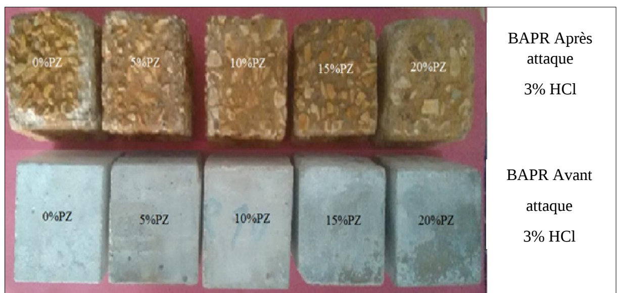
Figure 6.20: Examen visuel du BAPR avant et après attaque à 3% HCl.
