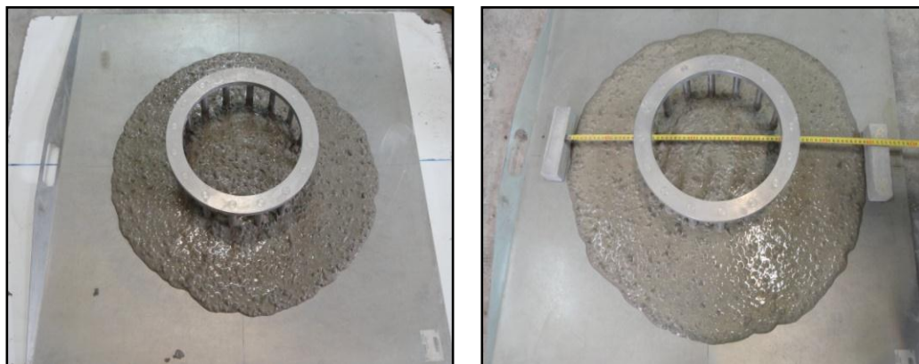
Figure 4.6 : Mesure d'étalement en présence du J-Ring.
