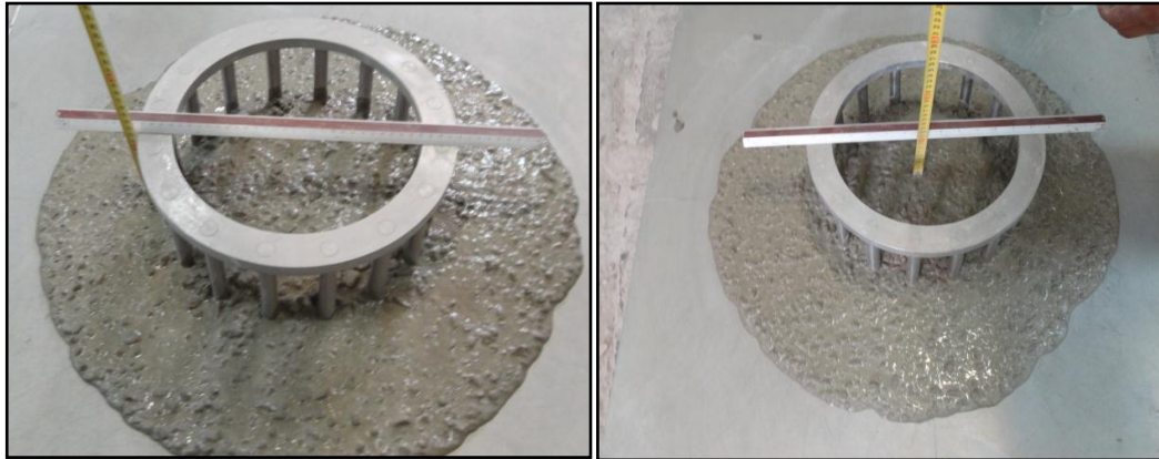
Figure 4.7 : Mesure des hauteurs à l'intérieur et à l'extérieur du J-Ring.
