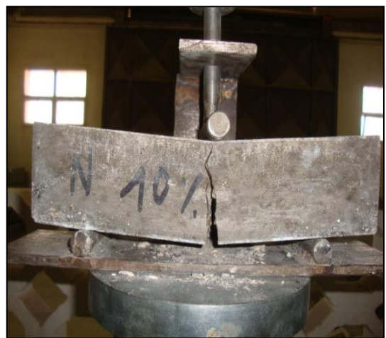
Figure 4.11 : Schéma de l'essai de traction par flexion à trois points.
