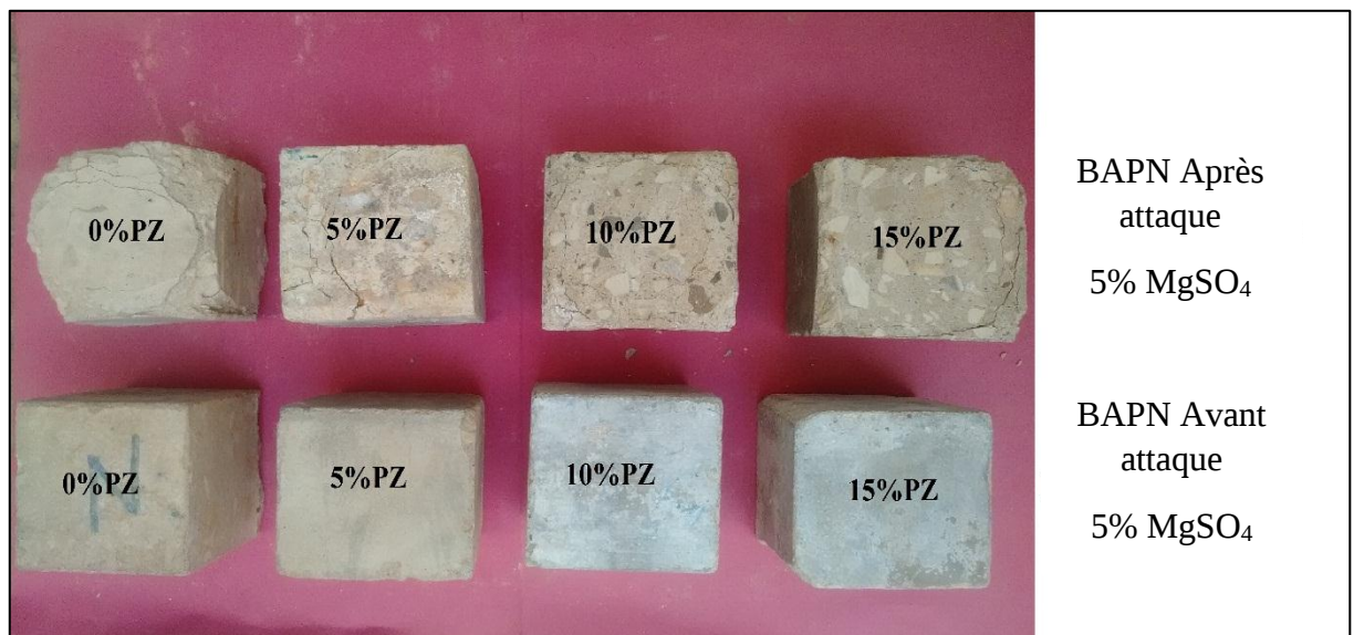
Figure 6.33: Examen visuel du BAPN avant et après attaque à 5% \text{MgSO}_4 .
