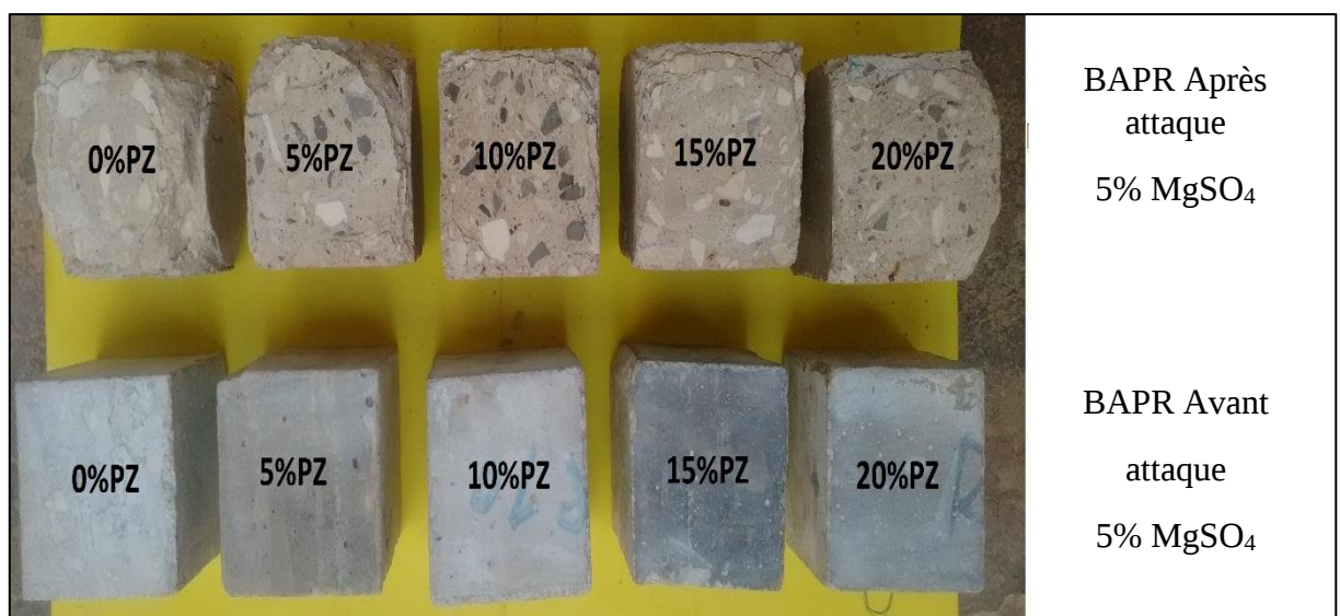
Figure 6.34: Examen visuel du BAPR avant et après attaque à 5% \text{MgSO}_4 .
