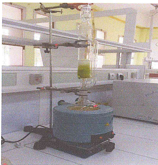
Figure III.2 : Montage de l'extraction des feuilles de S.Persica par Soxhlet.
