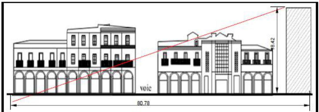
**Figure n°4,8** : Coupe montre le rapport entre la hauteur de l'édifice à droite et l'éloignement.
