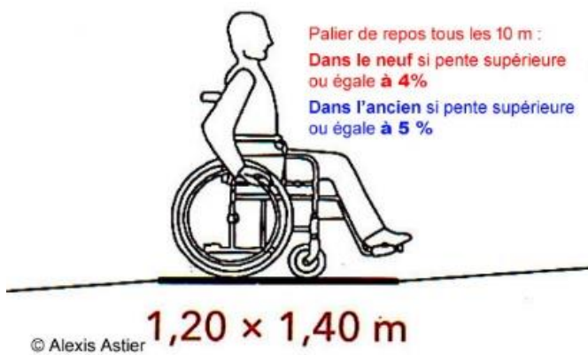
Figure : Les rampes pour les personnes à mobilité réduite
