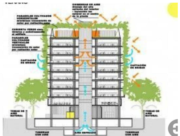
Figure : coupe d'immeuble avec mur extérieure végétalisée
