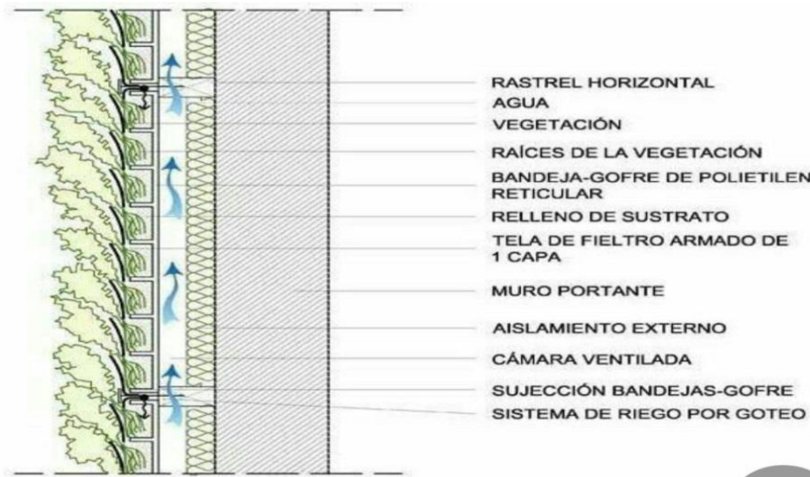
Figure : coupe détails mur végétalisé.
