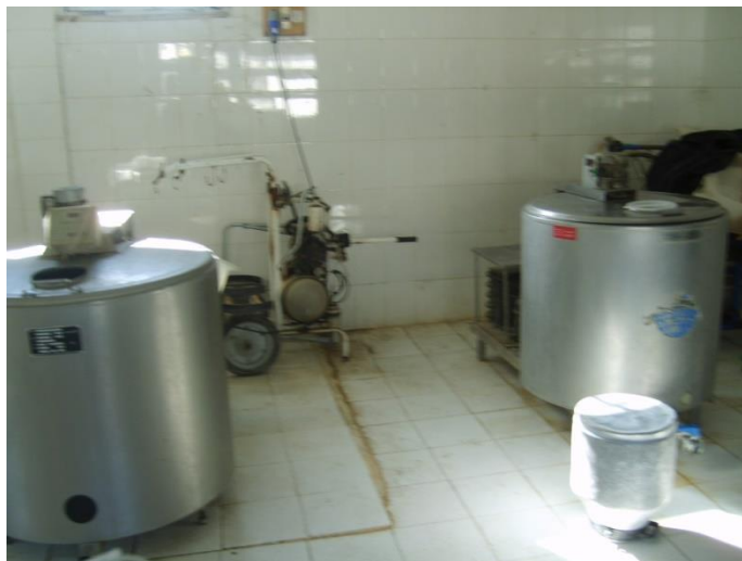
Figure 3.14 : Réservoir de refroidissement et stockage du lait au niveau de la salle de traite de l'ITELV Baba-Ali.
