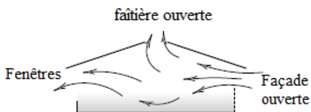
Figure 3.12 : Principe de la ventilation statique naturelle.
