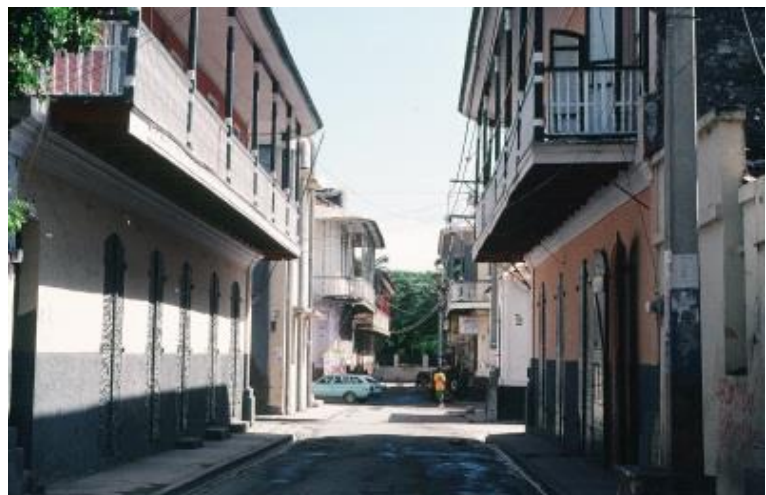
Figure II-13: Cap-Haïtien, rue ombragée protégée du soleil par l'enfilade des balcons filants des maisons mitoyennes alignées sur la rue
