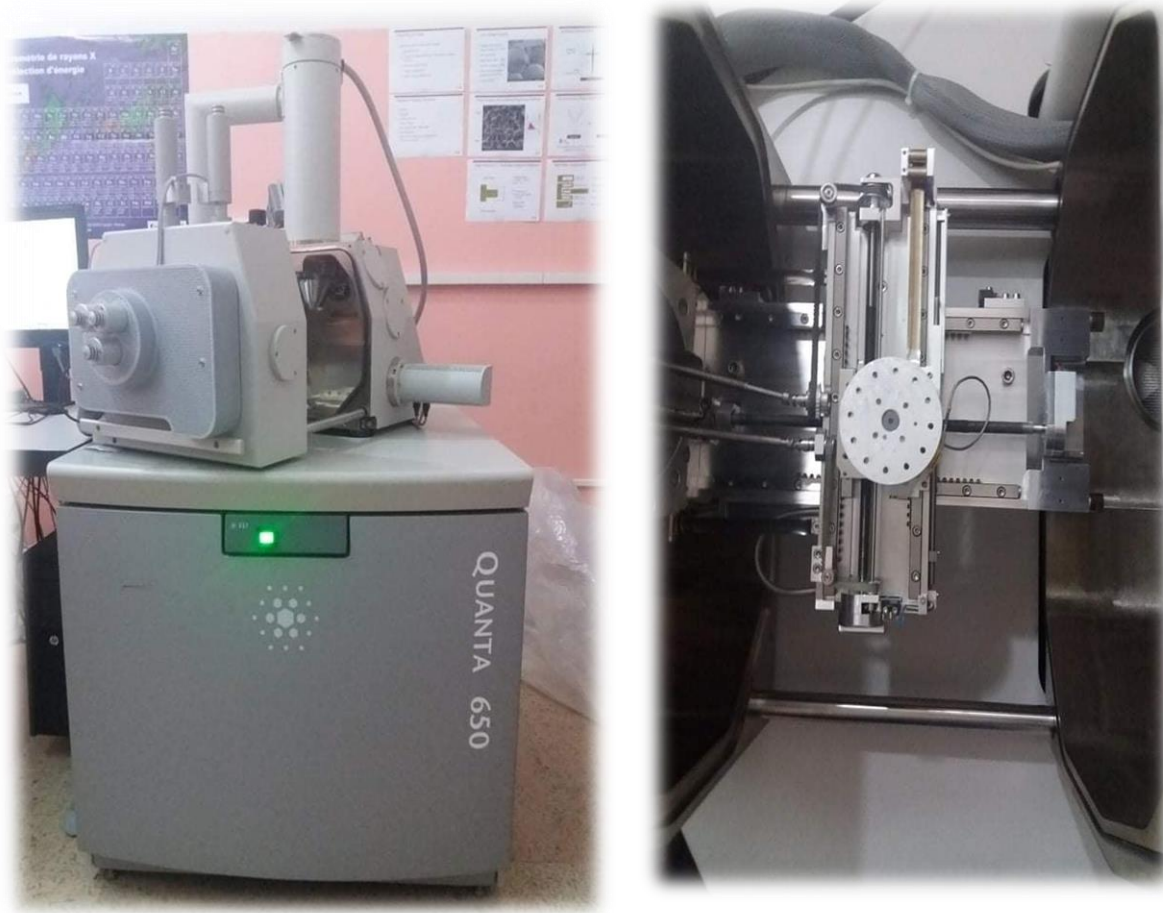
Figure II . 11: Dispositif de MEB Quanta 650 à gauche et vue de haut de la chambre d'analyse à droite.
