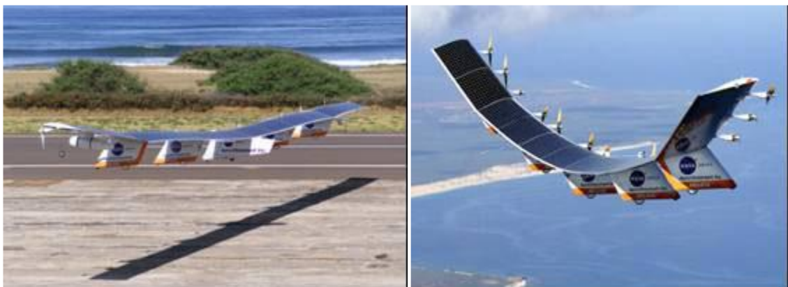
Figure (I-13) : le projet HELIOS à panneaux solaires.
