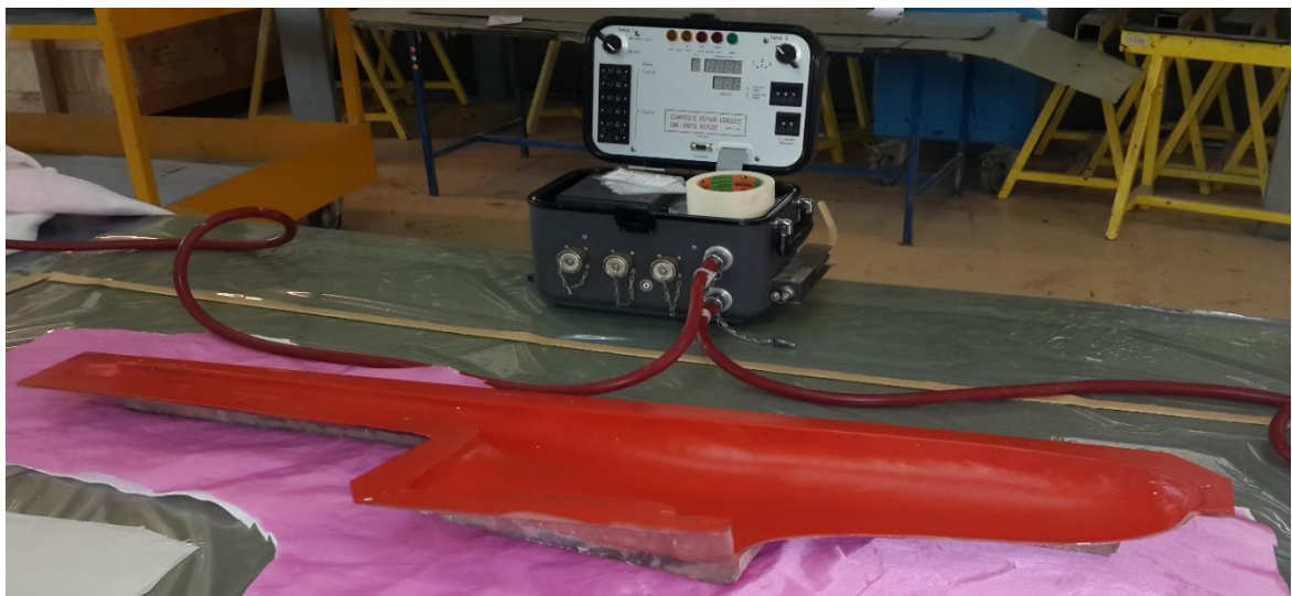
Figure (V-25) : Application de la pompe à vide.
