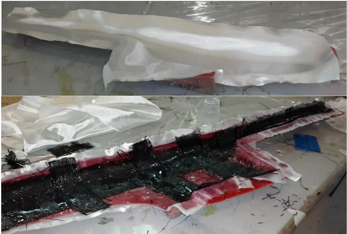
Figure (V-24) : Applications des différents tissus pour le moulage.
