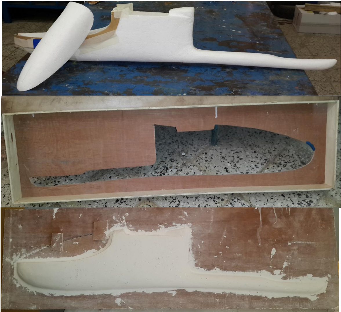
Figure (V-20) : Réalisation de cadre de centrage et renforcement de moule.
