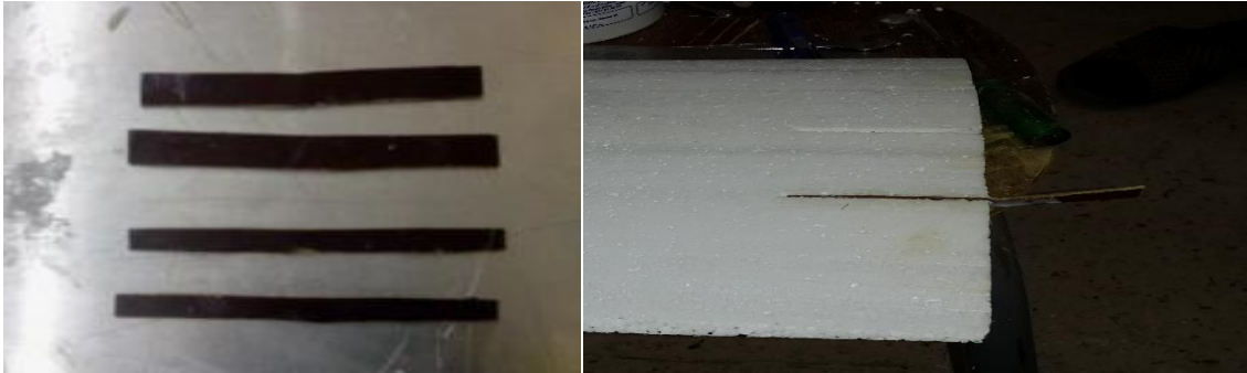
Figure (V-13) : Fixation des ailes avec des clés de jonction en Bakélite .
