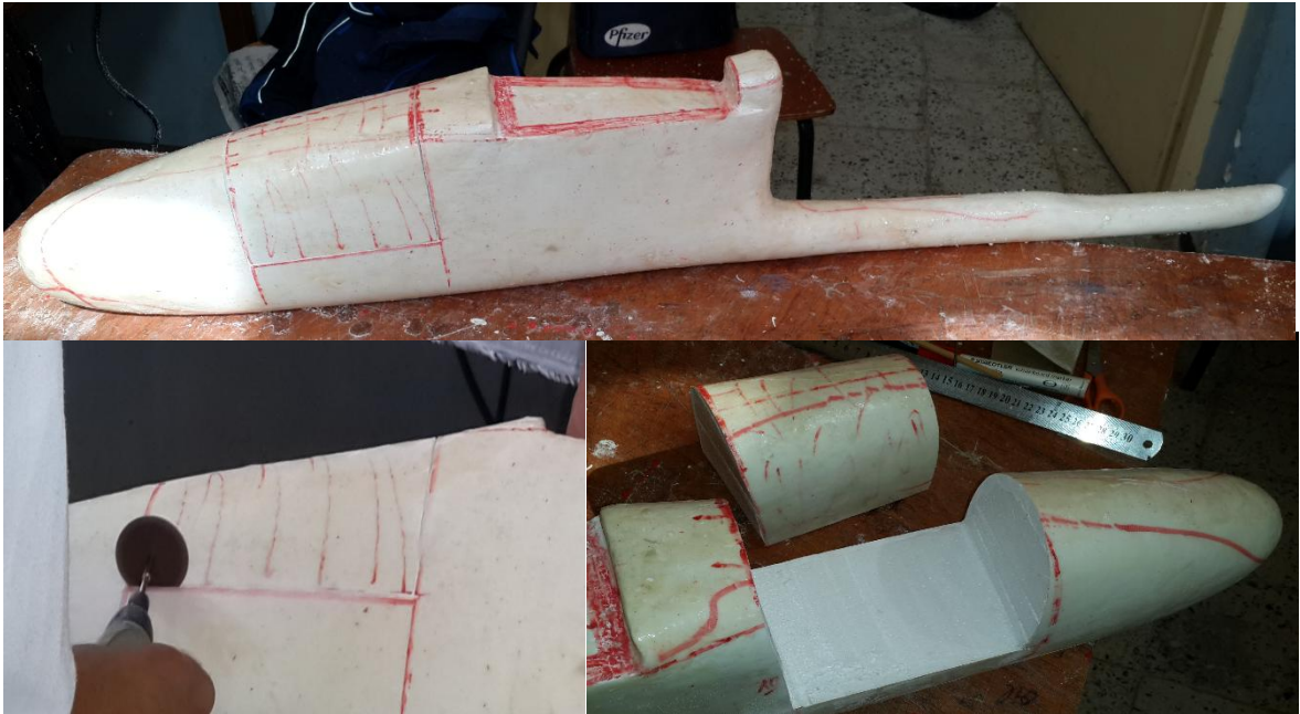
Figure (V-7) : Découpe de cache fuselage.
