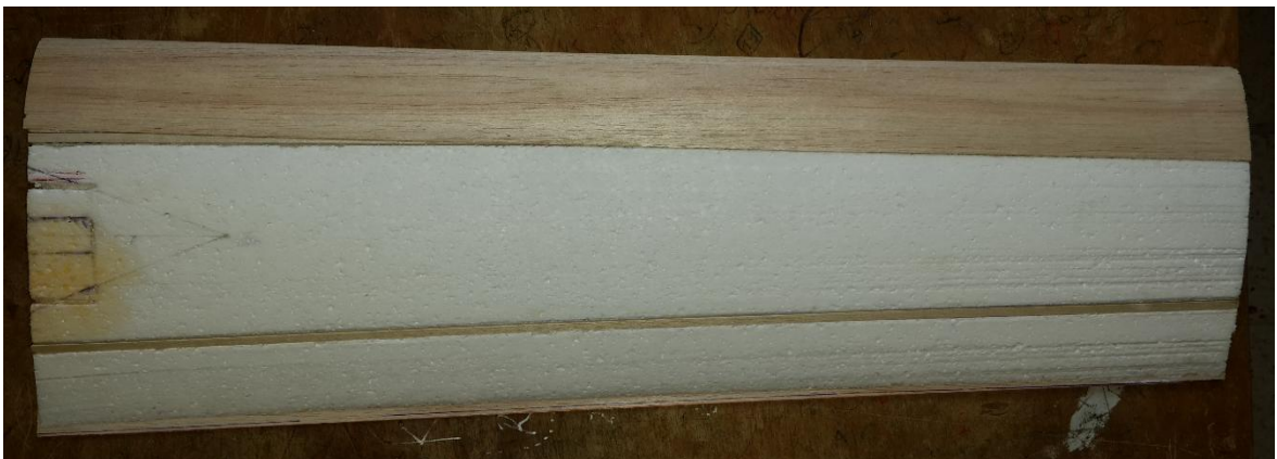
Figure (V-12) : Collage du longeron sur les ailes.
