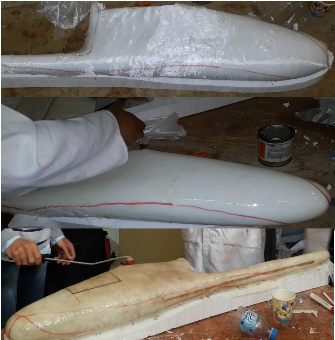
Figure (V-6) : Application de la résine époxy sur le fuselage.
