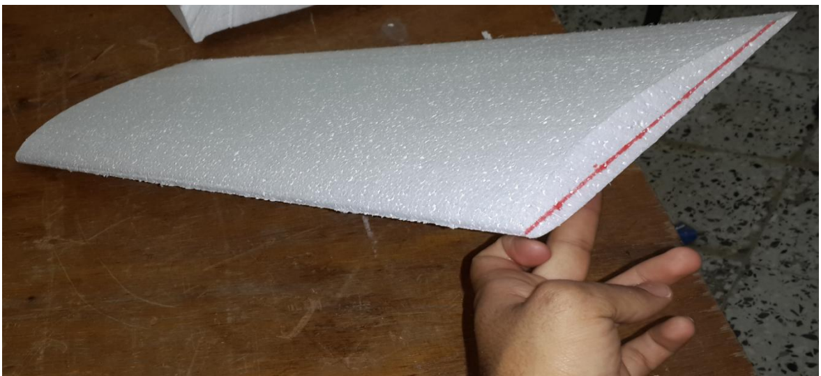
Figure (V-10) : Exemple de découpe d'aile à fil chaud.
