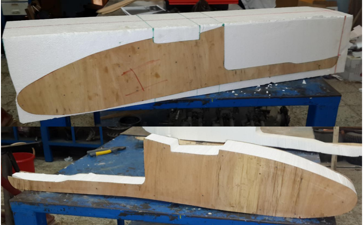
Figure (V-3) : Découpe de la vue de cotée de fuselage.
