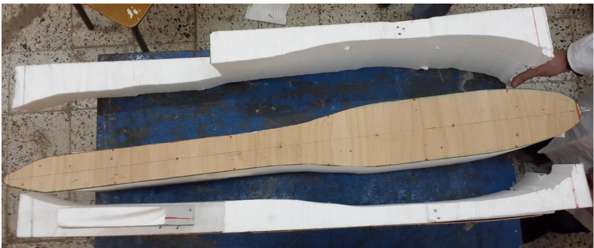
Figure (V-2) : Découpe de la vue de dessus de fuselage.
