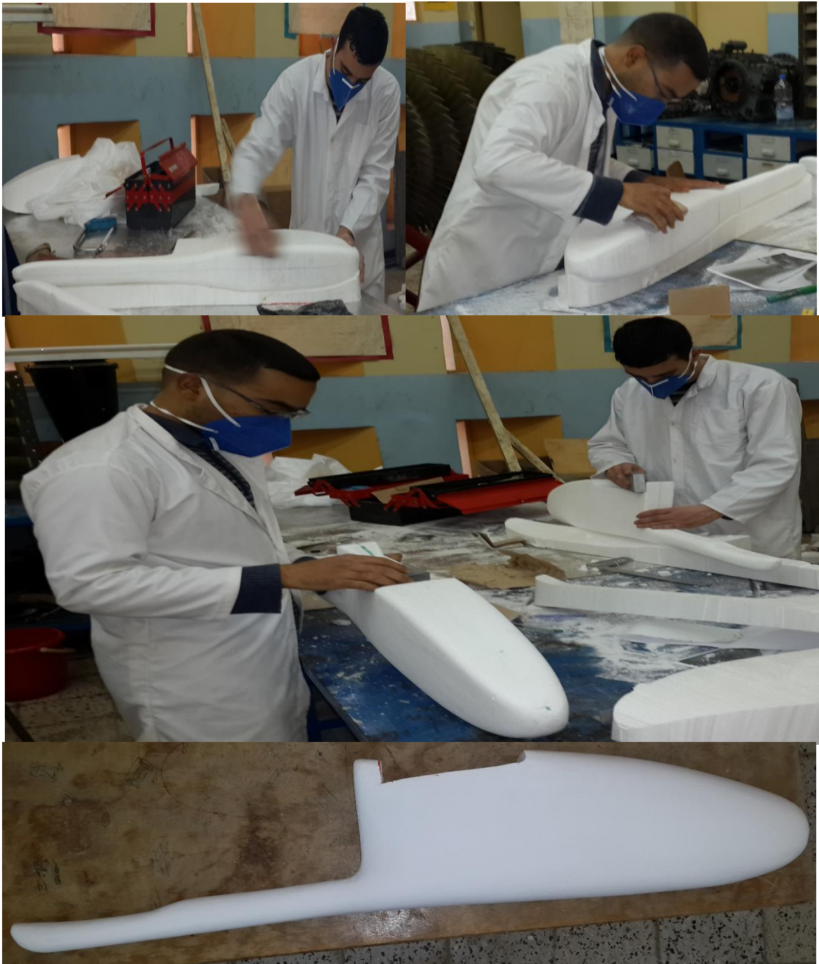
Figure (V-5) : Les différentes étapes de ponçage.
