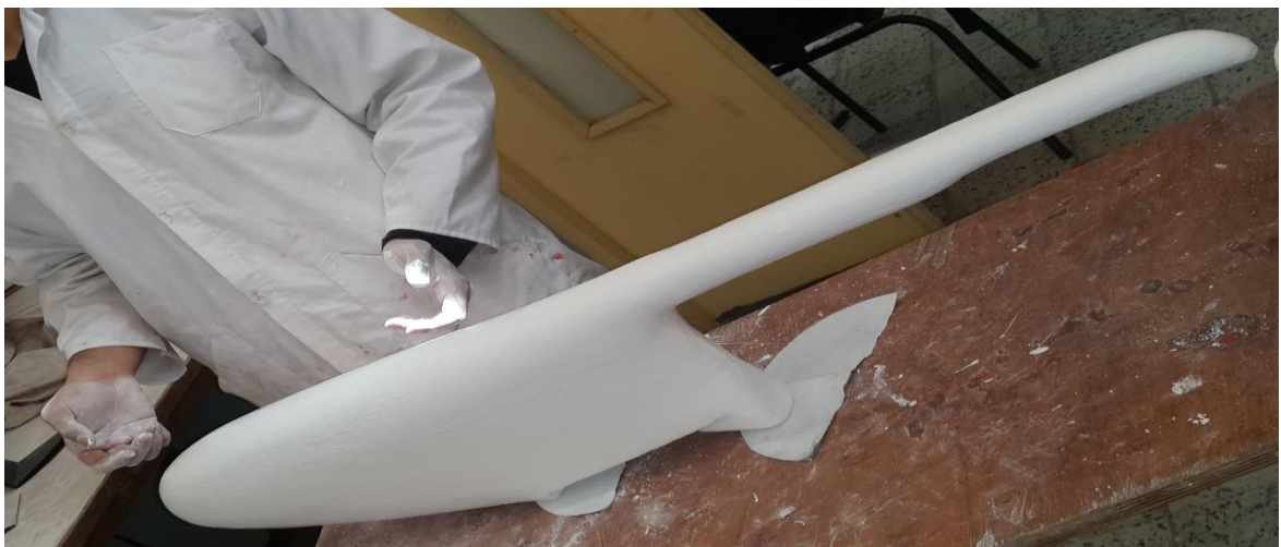
Figure (V-19) : Protection de modèle contre résine.
