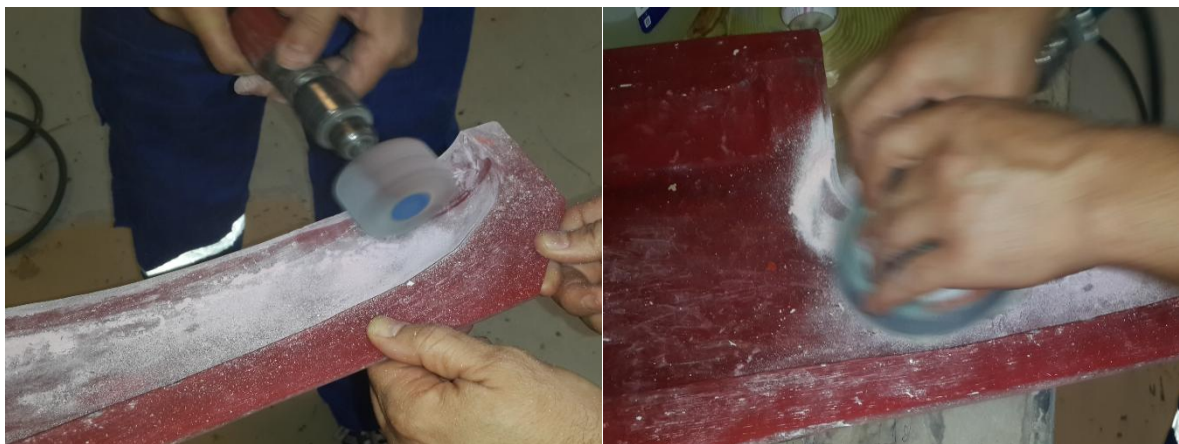
Figure (V-23) : Finition de moule.
