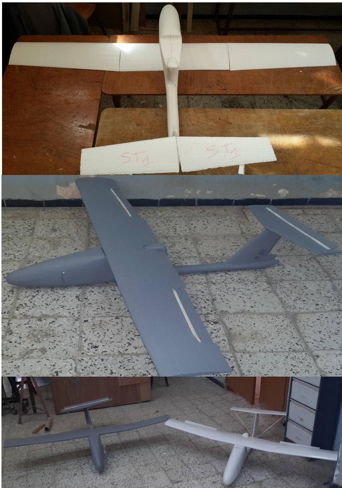
Figure (V-29) : Assemblage de l'avion complet.
