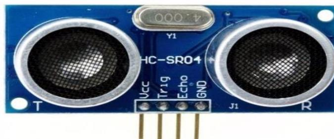
**Fig. 2.8** Capteur ultrason HC-SR04
