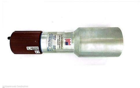
FIG. 2.3. Détecteur NaI avec la chaîne DigiBASE
