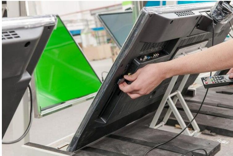
Figure I-5 : Test d'image sur la chaîne de montage
