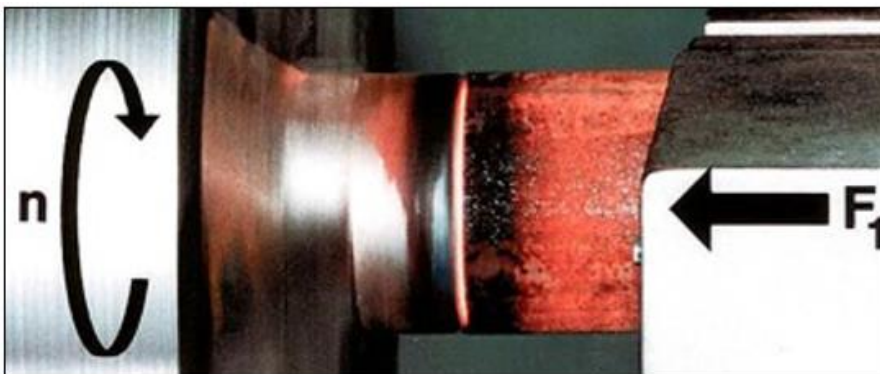
Figure II.7 — Les pièces sont mises en contact l'une de l'autre avec la force de friction F_1 : la température augmente dans la surface de contact
