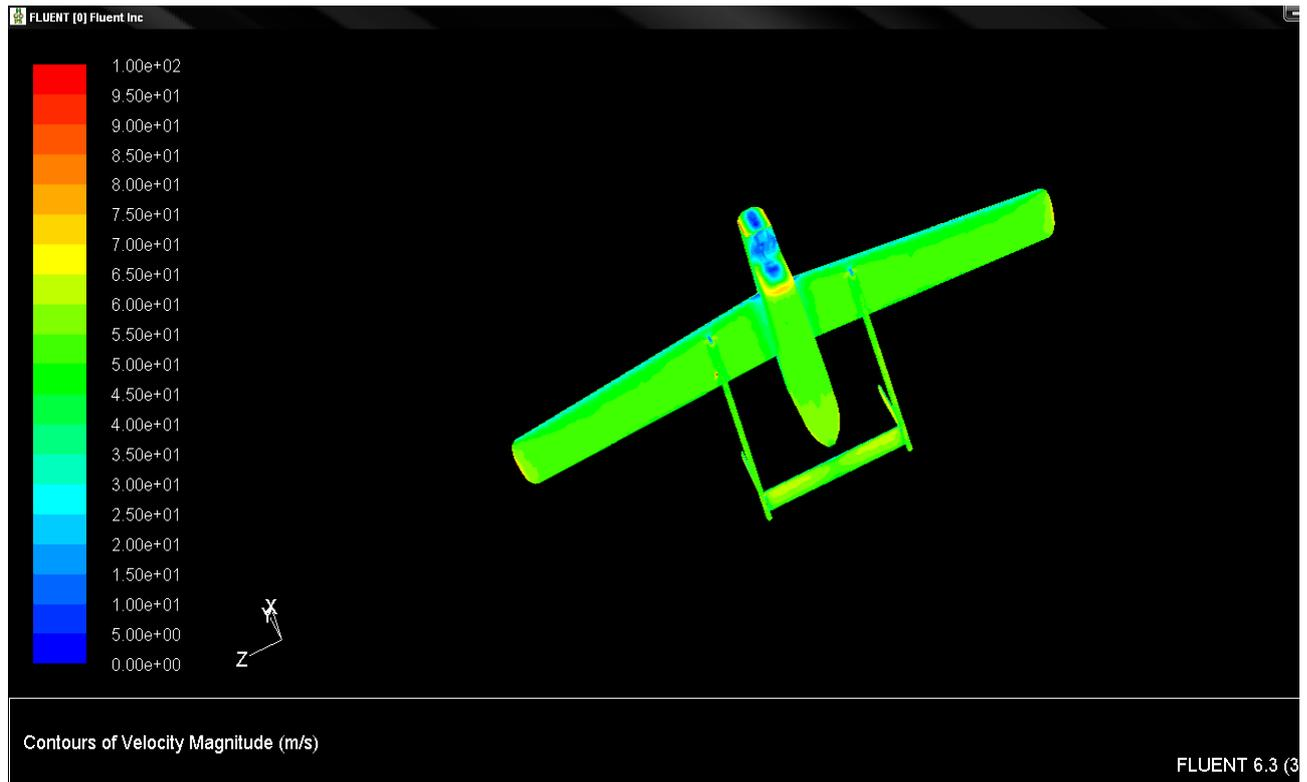
**Figure IV-84** : contours de velocity magnitude de la partie « intrados » (angle d'attaque 2°)
