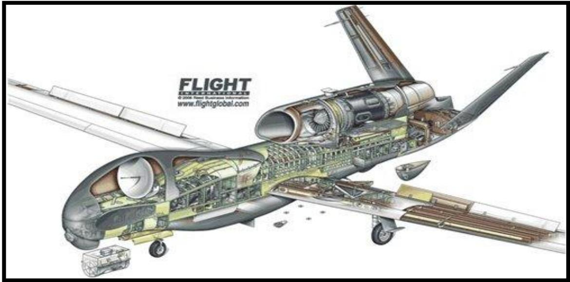
**Figure I-7 :** La cellule de drone Global Hawk.
