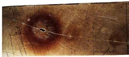
Figure 3 : par piqûres sur la paroi d'une cuve en acier inoxydable austénitique Cr18Ni10 [33].
