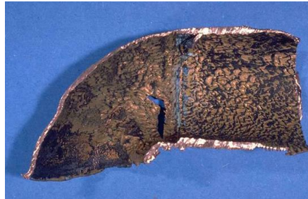
Figure 5 : Corrosion-érosion d'un tube en cuivre véhiculant de l'eau [33].
