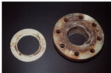
Figure 7 : Corrosion caverneuse d'un acier allié sous un joint [33].
