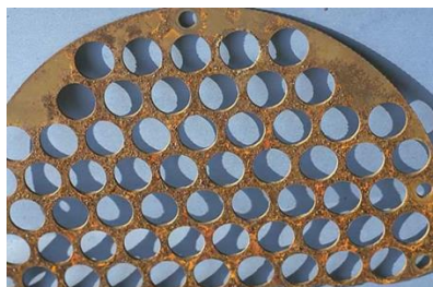
Figure 1 : Corrosion uniforme d'une chicane en acier dans un échangeur[33].
